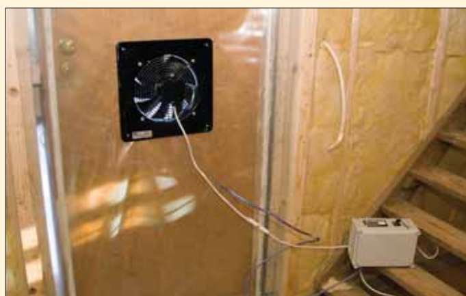
Det forenklete måleutstyret fra Systemair består av en motorisert vifte og en kombinert regulator og trykkføler, forbundet med kabel og påmontert måleslange.
